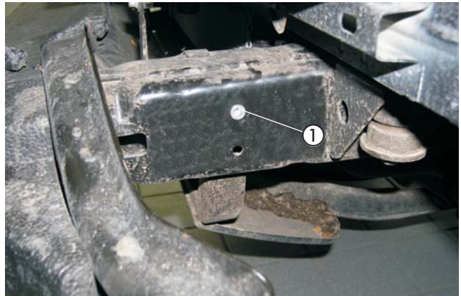
Abb. 20 ① Blindnietmutter M6 montiert
