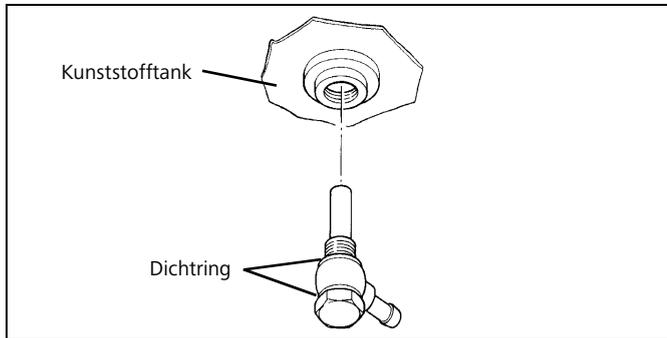
**Bild 10: Brennstoffentnahme aus dem Kunststofftank**
