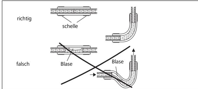
**Bild 13: Rohr/Schlauchverbindung**
