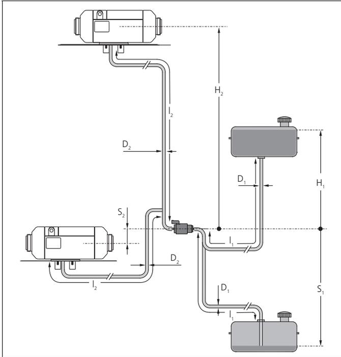
**Bild 12: Brennstoffversorgung**
