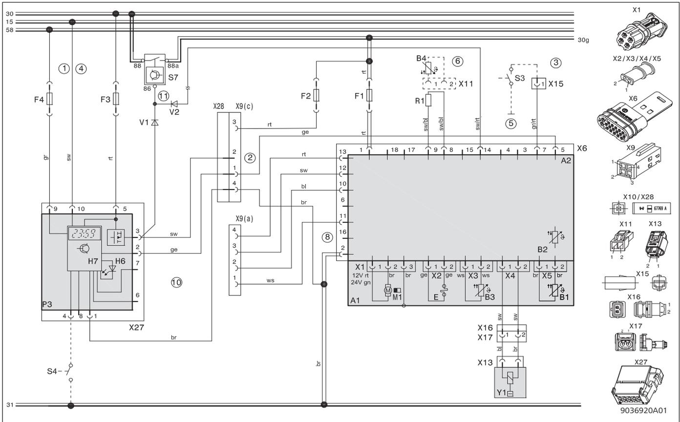
Bild 29: Systemschaltplan Air Top 2000 STC, 12 V/24 V mit UniControl / Batterietrennschalter, Legende siehe ab Seite 26
