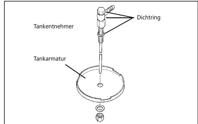
**Bild 11: Brennstoffentnahme aus dem Kunststofftank**
