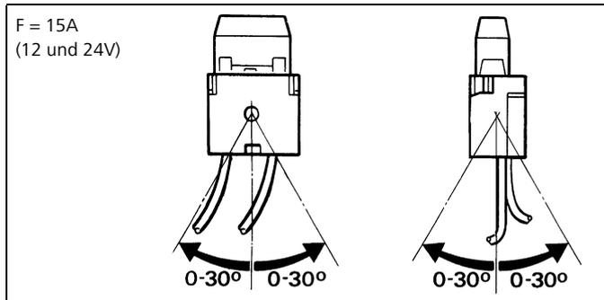
**Bild 23:** Sicherungshalter, Einbaulage
