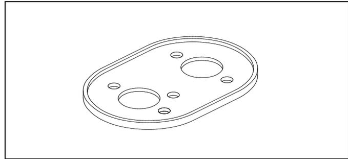
Bild 3: Dichtung
