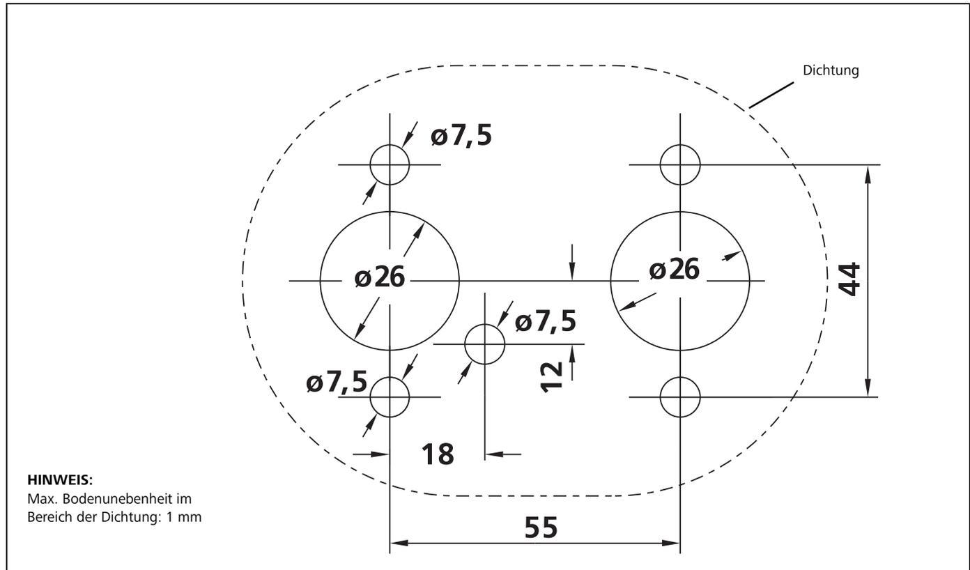
Bild 32: Bohrerschablone
