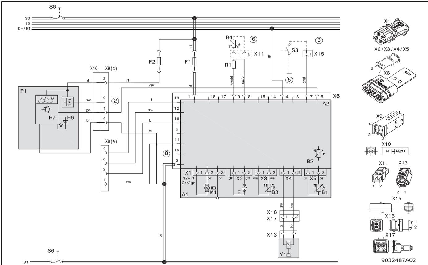
Bild 30: Systemschaltplan Air Top 2000 STC D, 12 V/24 V ADR-Betrieb mit SmartControl, Legende siehe ab Seite 26
