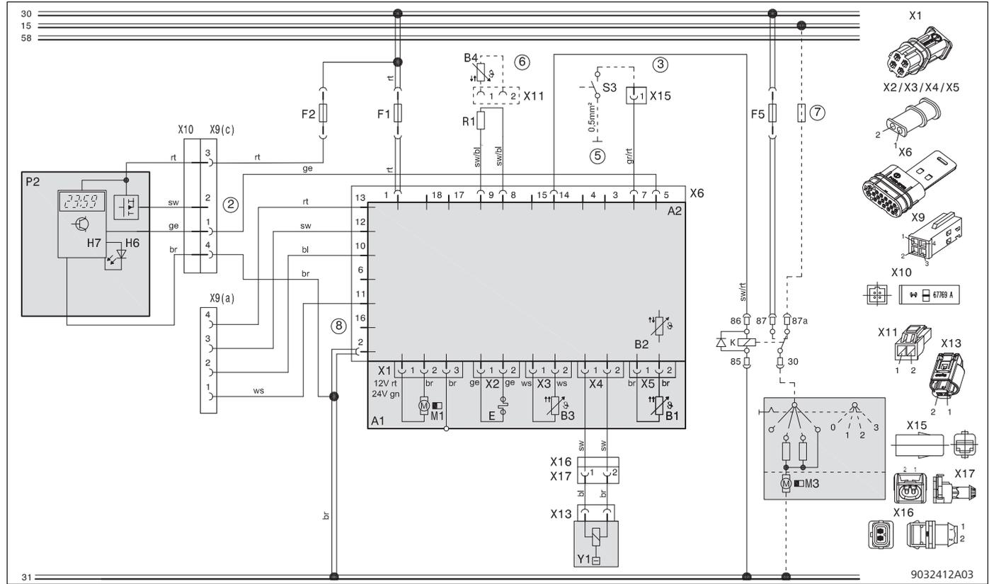
Bild 27: Systemschaltplan Air Top 2000 STC, 12 V/24 V mit MultiControl, Legende siehe ab Seite 26
