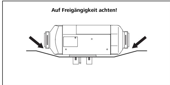
Bild 4: Einbau
