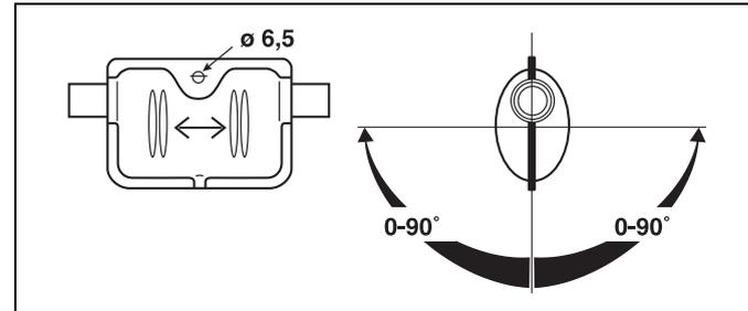
**Bild 20: Abgasschalldämpfer**
