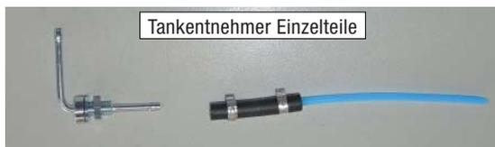
Das vorbereitete Brennstoffrohr  $\varnothing 4 \times 1$  mm auf den Tankentnehmer aufstecken und mit einer Klemmschelle  $\varnothing 10,5$  mm befestigen.
