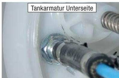
Die Tankarmatur in den Tank einsetzen und mit dem Verschlussring befestigen, dabei auf den richtigen Sitz der Dichtung achten.
