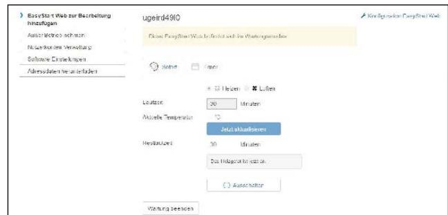
Nach erfolgreichem Durchlauf wird der Testbetrieb beendet. Dazu Schaltfläche **Wartung beenden** auswählen und anschließende Meldung bestätigen.
