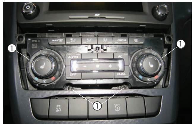
Abb. 2 ① Blende Radio/Klimabedienteil
