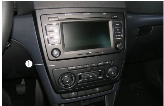
Abb. 1 ① Blende Radio/Klimabedienteil
