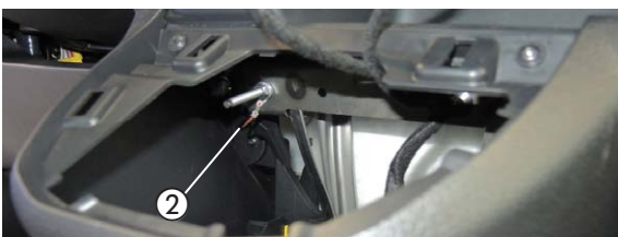
Kabel braun am Massepunkt der Mittelkonsole montiert
