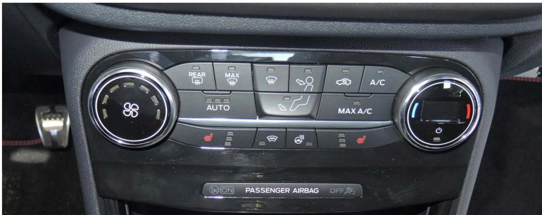
Abb. 2 Bedienteil Klimaautomatik
