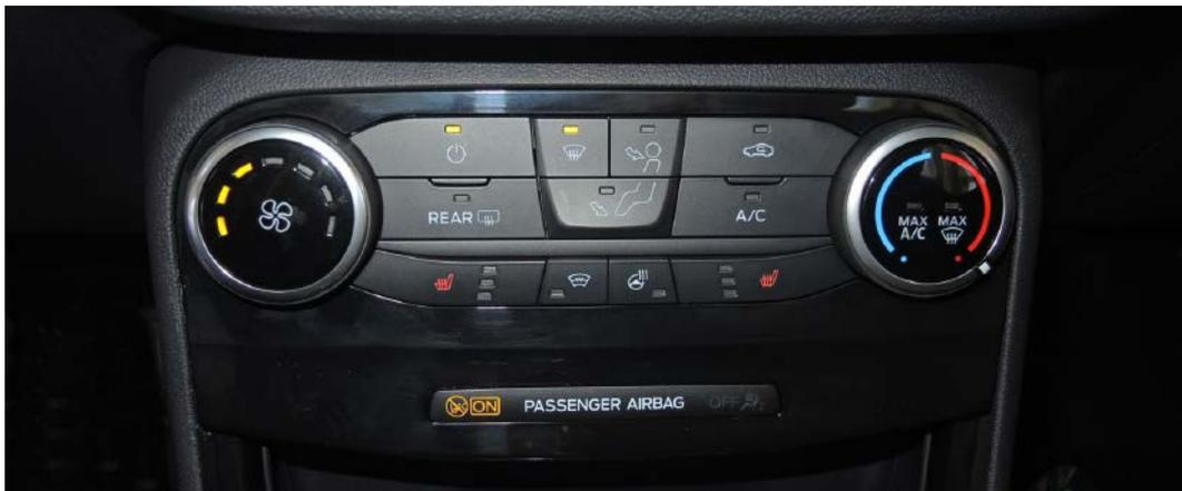
Abb. 1 Bedienteil manuelle Klimaanlage
