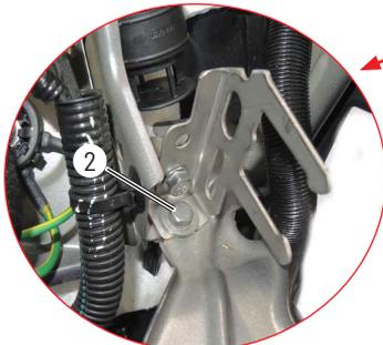
**Wasservorlaufschlauch und Wasserrücklaufschlauch trennen**
