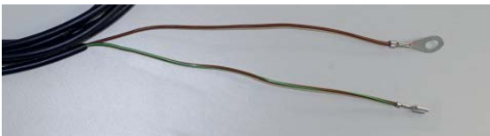
Mantelleitung mit Kabelschuh A6 und Steckhülse vorbereitet
