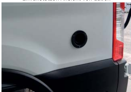
Einfüllstutzen Ansicht von außen
