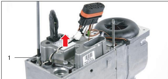
1 Befestigungsschraube Druckfeder Oberflächenfühler
