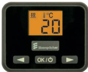
Treten am Heizgerät während des Betriebes Störungen auf, werden diese nach dem Aktivieren des Mobilteiles bzw. der Schaltuhr mit „Err“ angezeigt.
