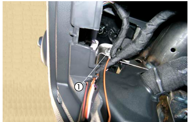
Abb. 45 ① Kabel 0,5 mm 2 br vom Gebläserelais montieren
