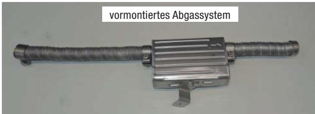
Die vormontierten Abgasrohre der Abbildung entsprechend vorbeugen.
